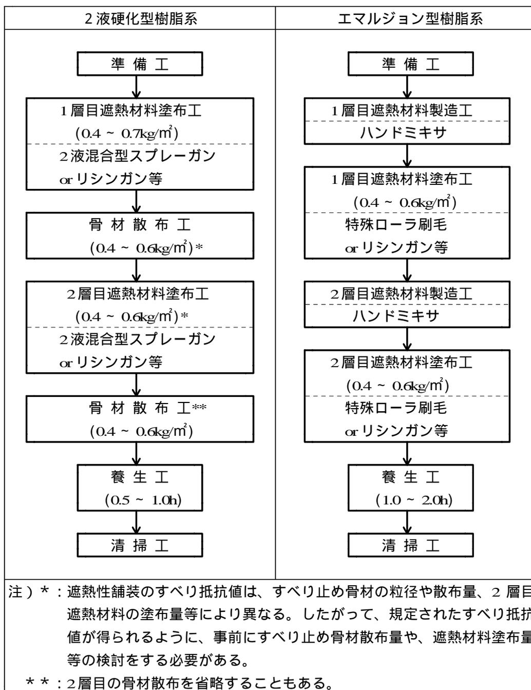
図 - 4 遮熱性舗装の施工手順
